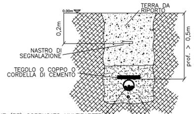
TUBO IN POLIETILENE (PE) CORRUGATO MULTIPARETE (LISCIO INTERNAMENTE, CORRUGATO ESTERNAMENTE) CORRISPONDENTE ALLA Norma CEI 23-46 TIPO N
